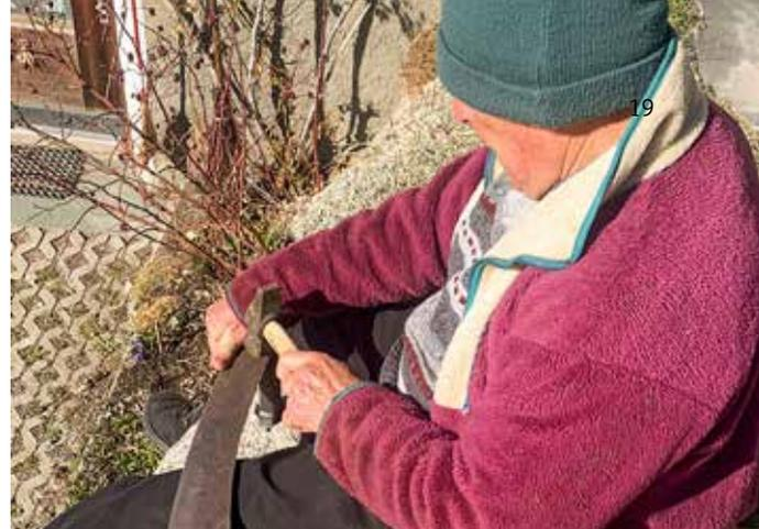
Die Schneide des Sensenblattes wird mit Hilfe eines speziellen Hammers und Ambosses so dünn ausgetrieben, bis die Sense rasiermesserscharf ist. (Foto: Lorena Lüscher)
